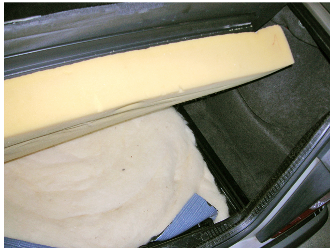
Abb. 3 - Einbau des Wärmespeichers in die Reserveradmulde eines Mercedes W124, Baujahr 1990.
